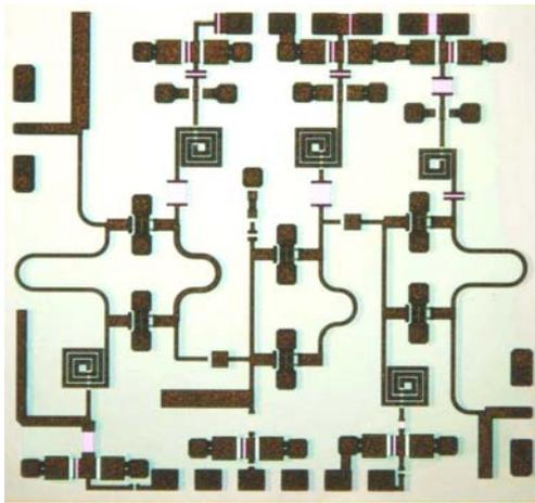
Fig. 2: Broadband LNA microphotograph
